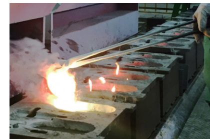
富加工場の鑄造工程
