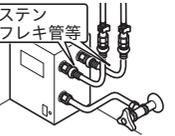
**必ず実行** 凍結が予想される際は、一般地仕様をお使いの場合は少量の水を出しておくか配管に布を巻くなどして凍結を防止してください。
