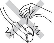
**禁止** 配管接続部をテーパねじに接続しないでください。
