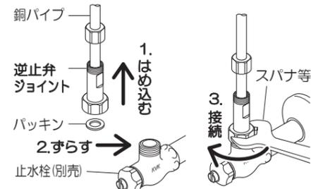
④ 逆止弁ジョイントが共回りしないように、別スパナで二面幅を固定しながらナットを締め付け、銅パイプと逆止弁ジョイントを接続します。
