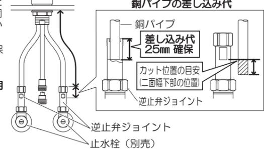
② 逆止弁ジョイントから図の部品をはずします。ナット、くい込みスリーブ、スリーブ、パッキンの順に銅パイプにはめ込みます。
