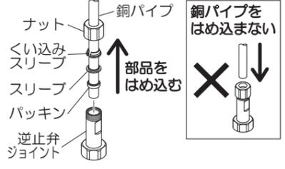
③ 逆止弁ジョイントを止水栓からはずした状態で銅パイプにはめ込んでから、止水栓と接続します。
