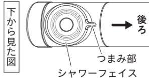
浄水カートリッジの交換1 / 取り付け・取りはずし
