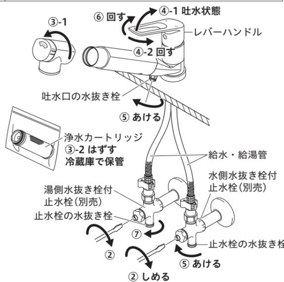
水抜き後 通水を再開する
