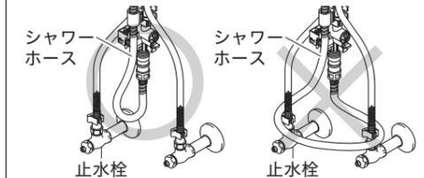
【△注意】電磁弁ユニットのストレーナが右を向いていることを確かめてください。ストレーナが右を向いていないと、コード類とシャワーホース・ブレードホースが絡まり、発火・ショート・感電の原因になります。
