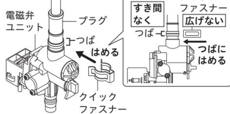
【△注意】電磁弁ユニットを下に引っ掛けて、抜けないことを確認してください。しっかりはまっていないと漏水して家財などを濡らす財産損害発生のおそれがあります。
