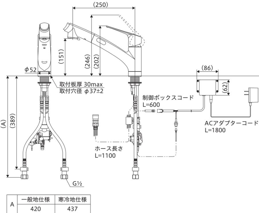
●水栓取付面からシンク下の底板(棚板)までの距離が575mm以上ないと、ホース収納時に底板(棚板)との干渉が大きくなり、使用上問題はありますが、ホース収納性が悪くなります。
