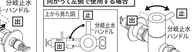
【△注意】分岐止水ハンドルは無理な力を加えずゆっくり操作してください。急な操作や無理な力での操作はウォーターハンマー(水撃)音が発生し、配管からの漏水により家財などを濡らす財産損害発生のおそれがあります。
