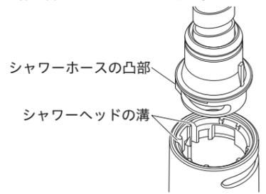
【お願い】止まるまで締め込んだら、それ以上締め込まないでください。破損するおそれがあります。締め付け不足の場合、漏水や切換不良の原因になります。
