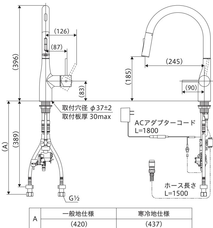
●水栓取付面からシンク下の底板(棚板)までの距離が575mm以上ないと、ホース収納時に底板(棚板)との干渉が大きくなり、使用上問題はありませんが、ホース収納性が悪くなります。
