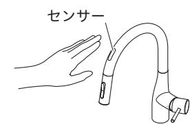
⑤ センサーまたはレバーハンドルを閉じて止水し、接続部からの水漏れがないことを確認してください。
