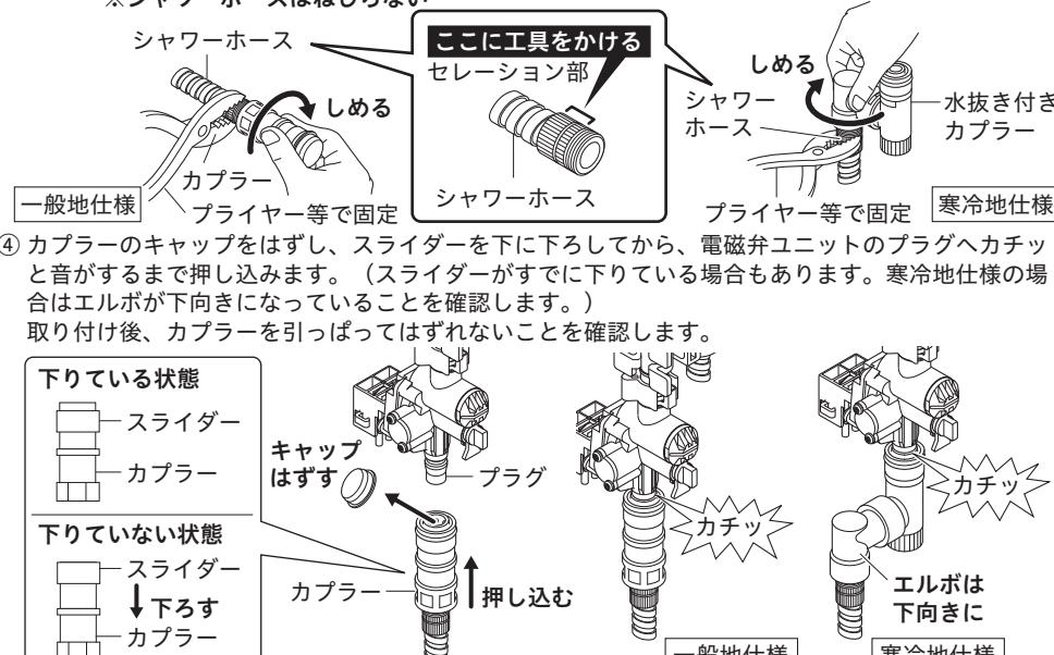
【△注意】シャワー ホースは止水栓に引っかけないで、給湯・給水パイプの間にぶら下げる取り付けてください。
