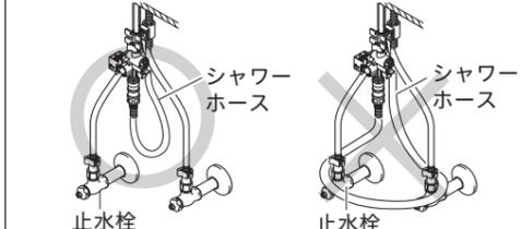
【△注意】電磁弁ユニットのストレーナが右を向いていることを確かめてください。ストレーナが右を向いていないと、コード類とシャワーホース・ブレードホースが絡まり、発火・ショート・感電の原因になります。
