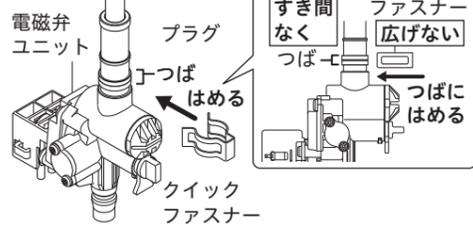
【△注意】電磁弁ユニットを下に引っ掛けて、抜けないことを確認してください。しっかりはまっていないと漏水して家財などを濡らす財産損害発生のおそれがあります。
