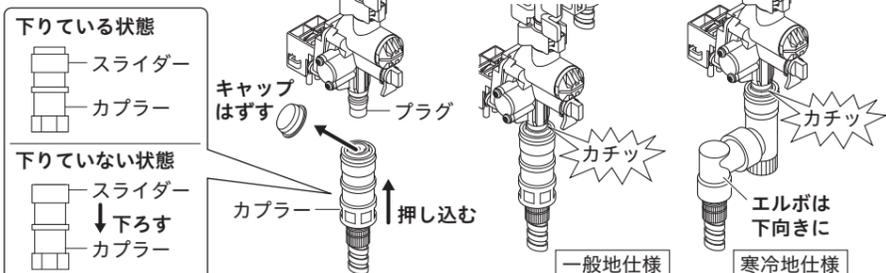
【△注意】シャワーホースは止水栓に引っ掛けなくて、給湯・給水パイプの間にぶら下げて取り付けてください。シャワーホースが引き出しにくくなったり、ホース損傷により漏水で家財などを濡らす財産損害発生のおそれがあります。
