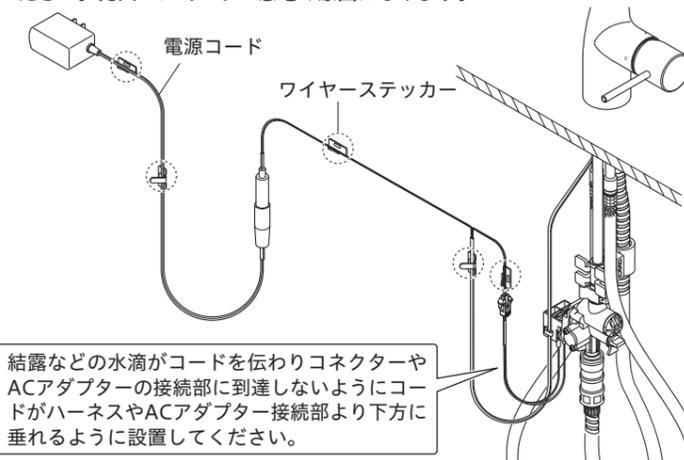
結露などの水滴がコードを伝わりコネクターやACアダプターの接続部に到達しないようにコードがハーネスやACアダプター接続部より下方に垂れるように設置してください。
