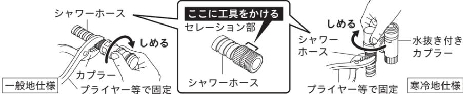
④ カプラーのキャップをはずし、スライダを下に下ろしてから、電磁弁ユニットのプラグへカチッと音がするまで押し込みます。(スライダーがすでに下りている場合もあります。寒冷地仕様の場合はエルボが下向きになっていることを確認します。) 取り付け後、カプラーを引っ掛けてはずれないことを確認します。
