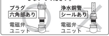
② クイックファスナーをプラグと電磁弁ユニットのつばにはめます。
