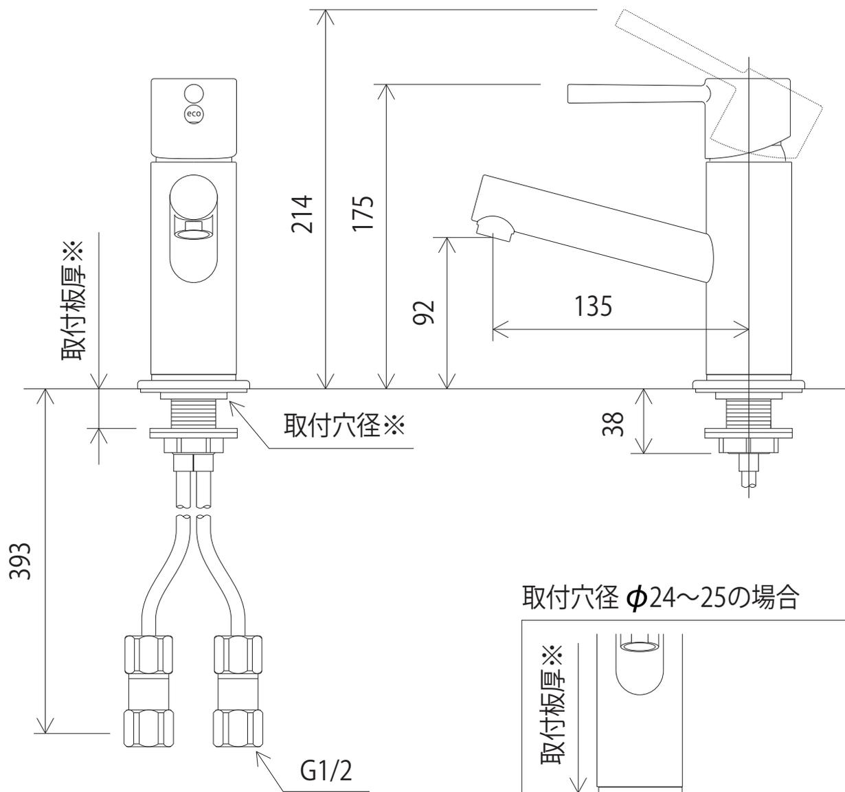
取付穴径  $\phi 24 \sim 25$  の場合
