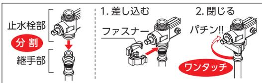
背板固定止水栓(分岐用)・継手分割型
