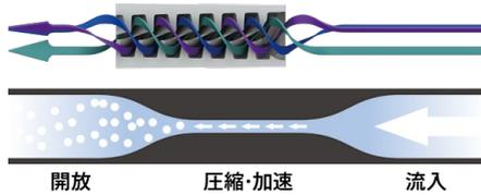
シャワーヘッド内のウルトラファインバブル発生装置に混合水が流入し、圧縮・加速させ開放することで泡を発生させます。
