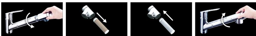
①シャワーヘッドを左に回して取りはずします。 ②カートリッジを抜き取ります。 ③新しいカートリッジを差し込みます。 ④シャワーヘッドを差し込みひねって取り付けます。
