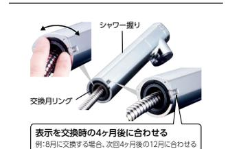
※1日10Lで使用の場合4ヶ月後が交換の目安となります。シャワー握りの浄水カートリッジ交換月リングを動かして、表示を4ヶ月後に合わせます。うっかり交換し忘れることを防ぎます。
