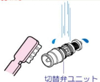
10 取りはずした逆の手順で取り付け、止水弁をあけてください。パイプまたはシャワーから水もれがないかを確認してください。
