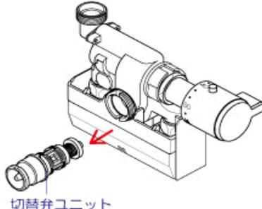
9 切替弁ユニットを水洗いで清掃します。切替弁ユニットに劣化・摩耗がみられる場合、新しい切替弁ユニットを用意します。
