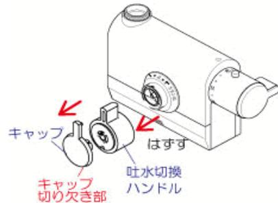
5 切換カラーを矢印の方向へ約30°回して引き抜いてはずします。
