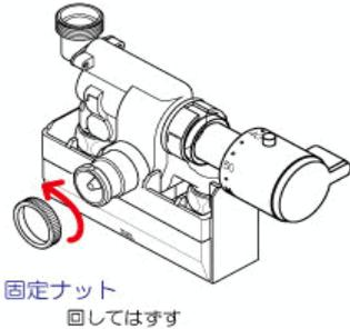
8 切替弁ユニットを矢印の方向に引き抜きます。
