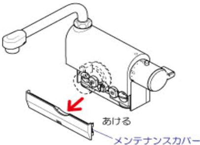
2 止水弁を締め、湯水が出ないことを確認してください。
