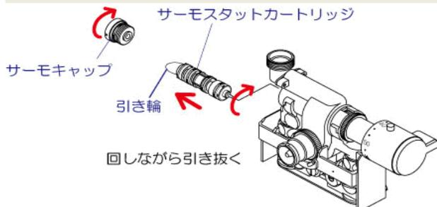
8 サーマスタートカートリッジを水洗いで清掃します。サーモスタートカートリッジに劣化・破損がみられる場合、新しいサーモスタートカートリッジを用意します。
