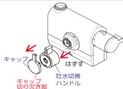
5 切換カラーを矢印の方向へ約30°回して引き抜いてはずします。(切換カラーがはずれない場合、切り欠き部にマイナスドライバーを引っ掛けて回してください)
