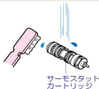
9 取り外した逆の手順で取り付け、止水弁をあけてください。温度調節ハンドルの設定を行い、温度調節が正常かどうかを確認してください。
