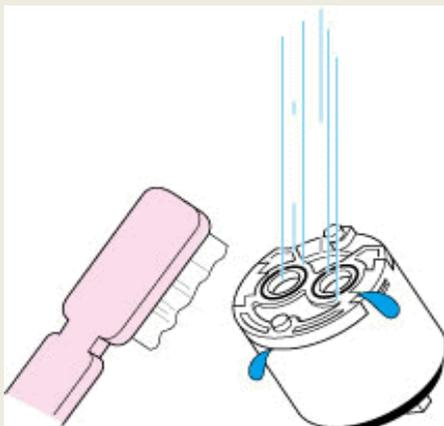
■カートリッジの清掃のあとも水もれがする場合、またはカートリッジの劣化・破損がある場合 ⇒新しいカートリッジを用意します。
