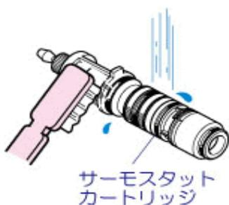
8 取り外した逆の手順で取り付け、止水弁をあけてください。
