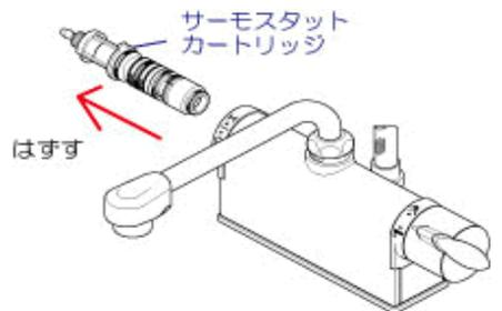
7 サーモスタットカートリッジを水洗いで清掃します。サーモスタットカートリッジに劣化・破損がみられる場合、新しいサーモスタットカートリッジを用意します。
