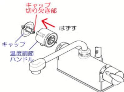
5 セレクションリングをはずし、温調側ナットをスパナなどで矢印の方向に回して取りはずします。
