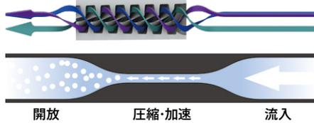
シャワーヘッド内のウルトラファインバブル発生装置に混合水が流入し、圧縮・加速させ開放することで泡を発生させます。
