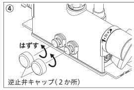
⑤ 湯水の水抜き付逆止弁をあけて水を抜きます。
